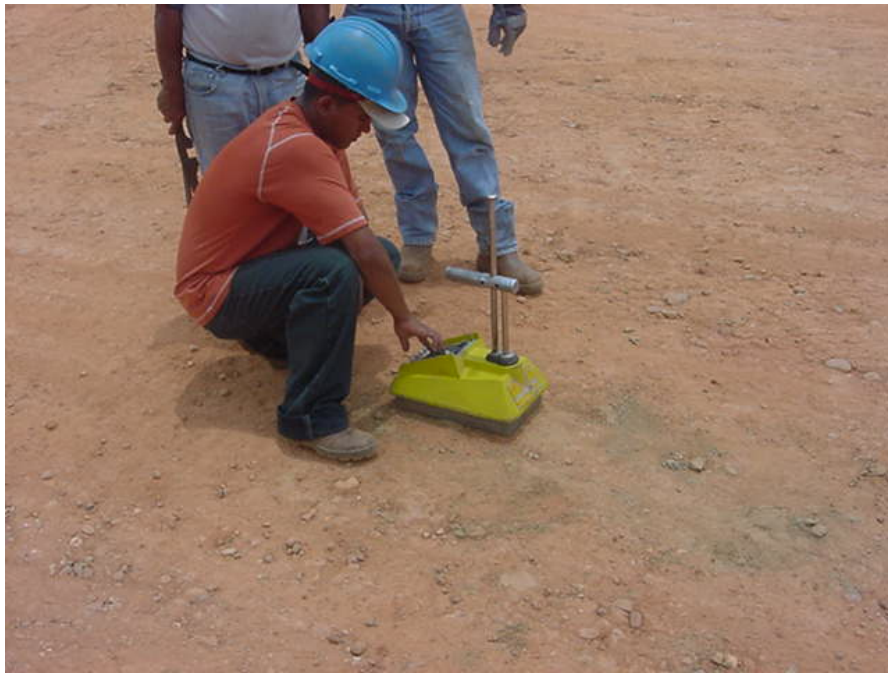
Figura 3; Ensayo de densidad de Compactación y Humedad con el Densímetro.
