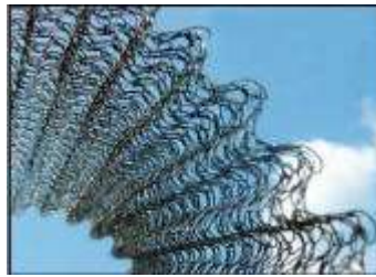
Figura 13. Tipo de tejido de alambre metálico típico de un eliminador de neblina tipo malla.
